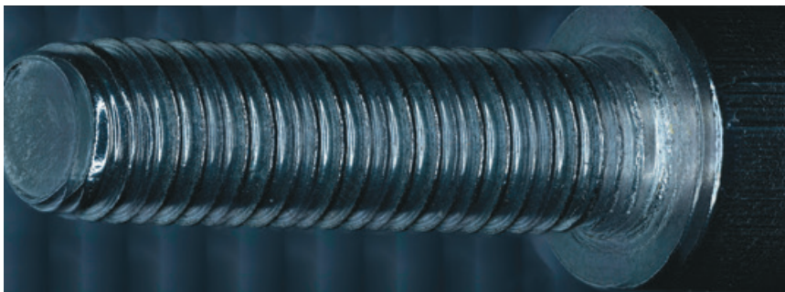
Винт, 3D-сшивка, увеличение – 80х
